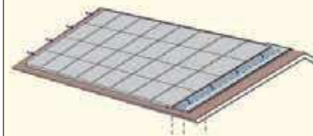
Abb. 18: Fotovoltaik auf bestehendem Dach mit Luftführung giebelwärts und Giebelabdeckung
