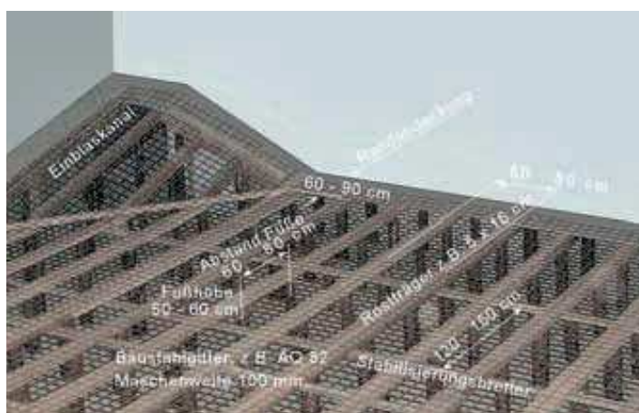
Beispiel für die Gestaltung des Bodenrosts.
