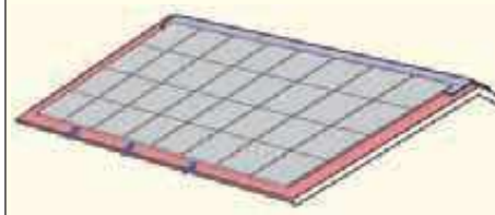
Abb. 18: Fotovoltaik auf bestehendem Dach mit Luftführung giebelwärts und Giebelabdeckung
