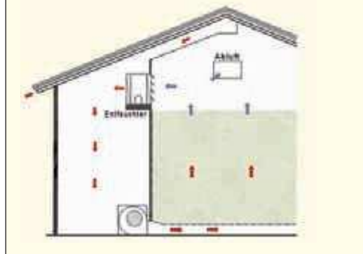
Abb. 23: Schema einer Luftentfeuchtung im Nebenstrom
